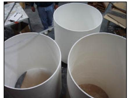
Los cilindros en CB76 son ideales para la inducción en aplicaciones para la forja. Son virtualmente a prueba de choque térmico. Los cilindros en CB76 se pueden producir en una amplia gama de medidas
