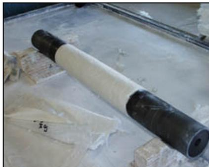
El material CB96 se usa para proteger la sujeción del grafito cuando se sumerge en Aluminio fundido. El material CB96 se pegará al grafito y no reaccionará o se sublimará. Es muy fácil de usar.
