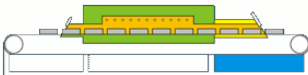
Esquema Horno con Banda Transportadora Mesh-Belt Furnace Scheme
